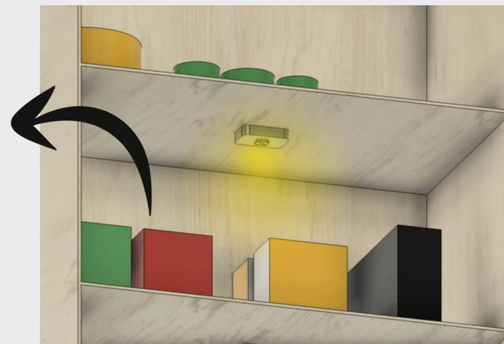
El dispositivo se instala fácilmente en las repisas de la **despensa o refrigerador** para **capturar imágenes** y de manera **automática reconocer los alimentos con IA** (PyTorch, Google Cloud Vision) para luego **visualizar el stock en una app**.
