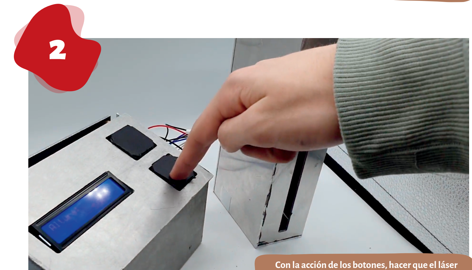
2 Con la acción de los botones, hacer que el láser suba o baje para alcanzar la altura deseada. Esta se puede leer en la pantalla.
