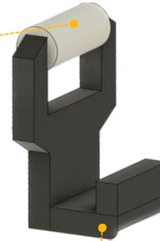
Gancho en forma de J para encajarlo en los orificios de la caja verdulera. El material será madera resistente.
